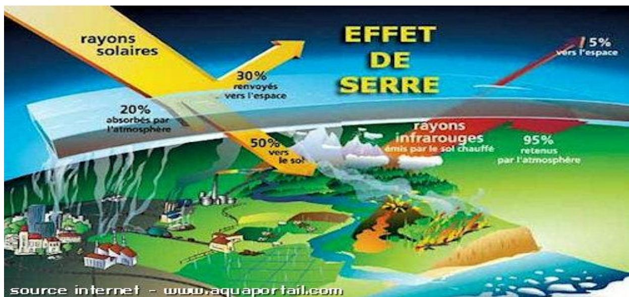
Figure 2 : Le mécanisme de l'effet de serre sur la terre
