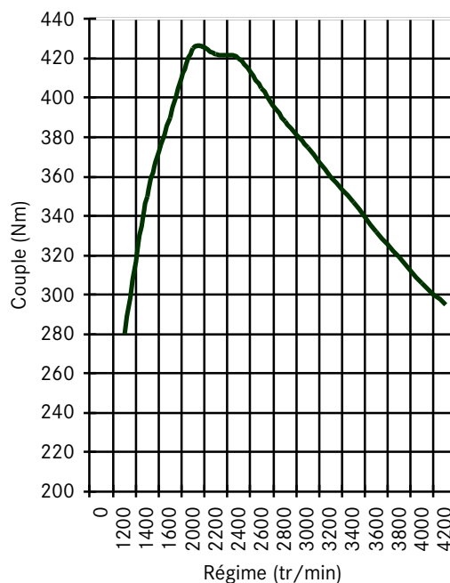
E 270 CDI Mercedes-Benz : 425 Nm à 2000 tr/min
