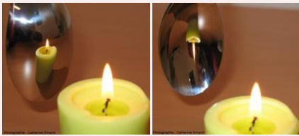
A gauche : Image dans un miroir convexe. A droite : Image dans un miroir concave.
