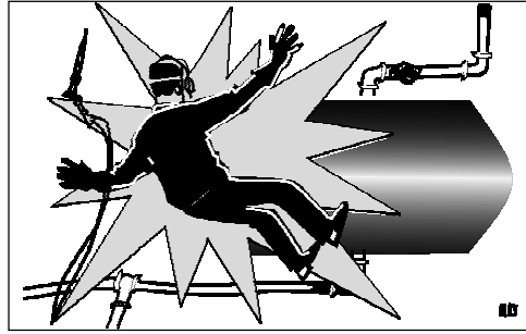
Figure 1 : explosion due à un dégazage incomplet
