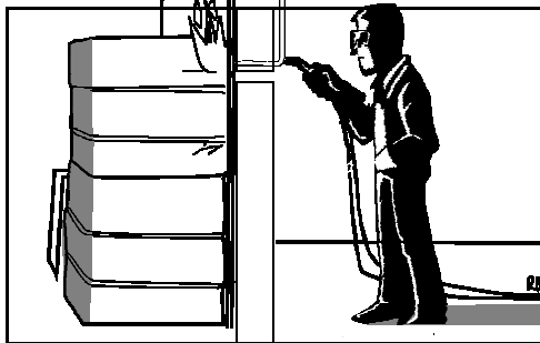
Figure 2 : inflammation au contact de conduites invisibles chauffées
