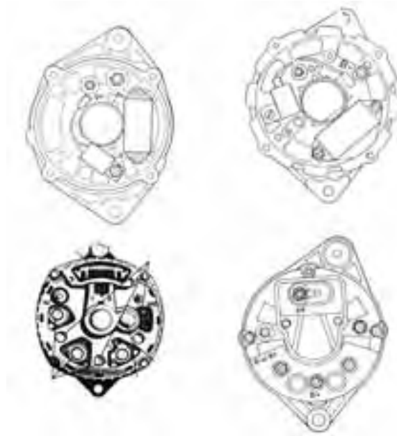
(شكل ١ أطراف التوصيل لمولدات تيار متناوب مختلفة)
