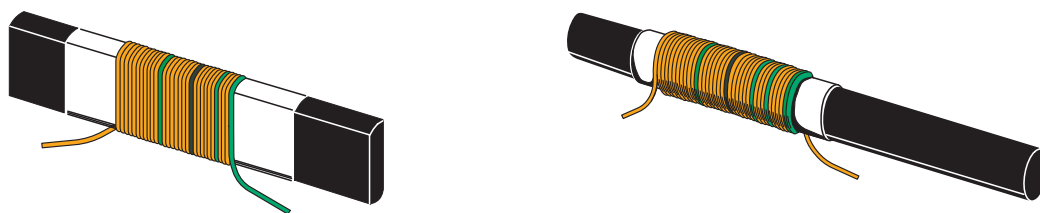
Fig.1 L'antenna in ferrite può avere un nucleo di forma rettangolare o cilindrica.
