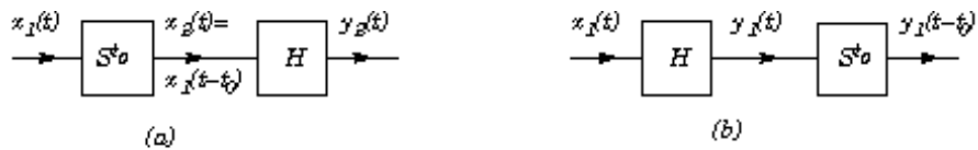
FIG. 1.43 – a) L'opérateur S^{t_0} précède l'opérateur H . b) L'opérateur S^{t_0} suit l'opérateur H .
