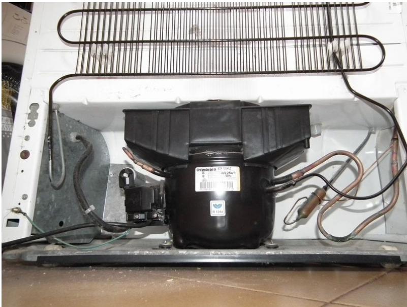
Plaque en tôle galvanisée à gauche de la photo, 3 visse à retirer...
