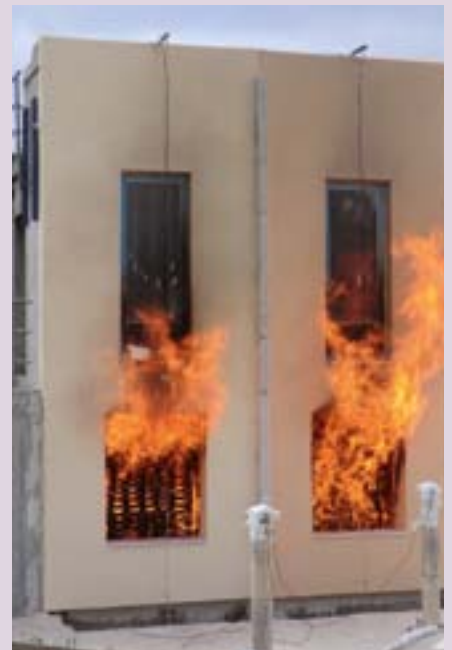
Photo 5 Essai Lepir 2 réalisé au CSTB avec un isolant à base de bakélite.
