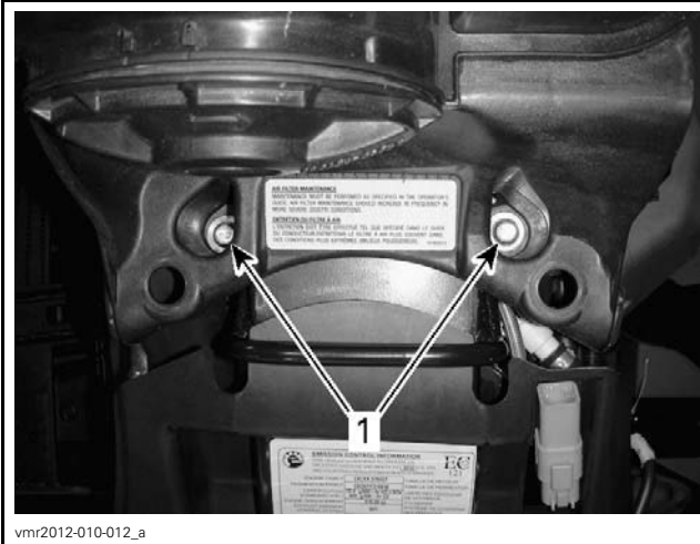
vmr2012-010-012_a VIS SITUÉES PRÈS DU DISPOSITIF D'ANCRAGE DU SIÈGE 1. Vis de fixation du boîtier de filtre à air
