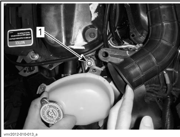
vmr2012-010-013_a VIS SITUÉE SOUS LE RÉSERVOIR DE LIQUIDE DE REFROIDISSEMENT 1. Vis de fixation du boîtier de filtre à air
