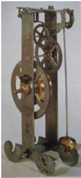
La pendule de Galilée et son mécanisme
